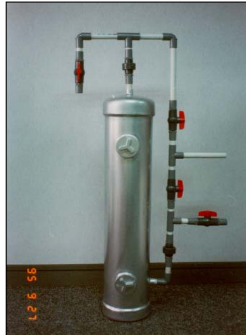
Gambar filter yang telah siap di pasang.
